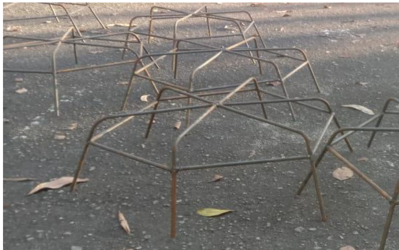
Gambar 6. Rangka Besi SPIDER untuk Media Transplantasi
