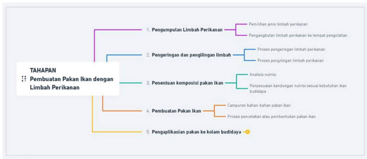
Gambar 1. Tahapan pembuatan pakan ikan dari limbah perikanan
