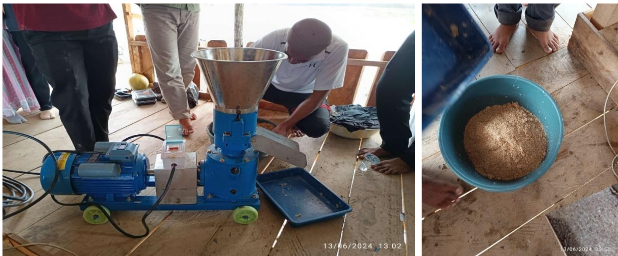
Gambar 2. Instalasi mesin pembuatan pakan ikan dan persiapan bahan
